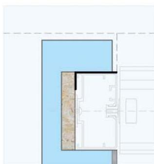
**B** Spalla priva di paraspirolo e di fibrocemento dopo la guida, profilo a L in lamiera. Finitura e spigolatura esterna a carico dell'impresa.
