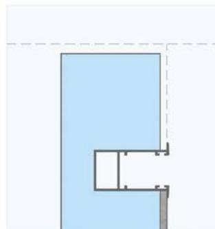
**B** Spalla priva di paraspigolo e di fibrocemento dopo la guida. Finitura e spigolatura esterna a carico dell'impresa.
